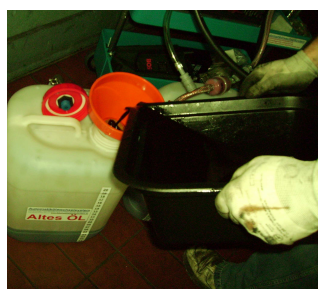
Adesso ci sono ca. 8/(7) litri olio usato nel bidone. Olio nuovo ca. al segno 8/(7) litri . (Caso mai dopo: Se il convertitore è provvisto di un tappo scarico olio, l'olio può essere scaricato anche nel bidone olio usato ). (sedimento di usura nella coppa d'olio).
