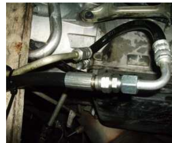
Dal Sprinter nuovo / Chrysler 300 C 3.0CRD 5G con collegamento a spina nella vite cava, montare il sistema a spina 7-G(della ClasseB) Attenzione: dal 300C V8 si può misurare il livello olio solo con l'asta controllo olio di Chrysler!
