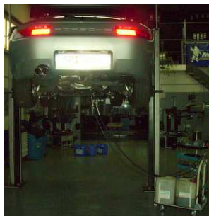
Porsche 928 S4 con cambio automatico MB. Lavaggio come dal 7-marce, siccome non c'è asta di controllo olio però tanica di trabocco accanto alla coppa d'olio!
