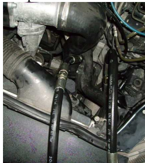
Adattatore ad angolo al W168, 170CDI e Vaneo. Cambio olio con 7,5 litri.
