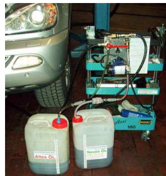
coppa d'olio con motore in marcia +marcia in D (Modo S) (funziona solo, se tutte le ruote motrici sono bloccate ) non accelerare Se viene tanta aria pompare dentro 1,5 litri olio nuovo . Poi svuotare ancora una volta se viene tanta aria cambiare in modo W/C poi inserire marcia. R e spegnere il motore.
