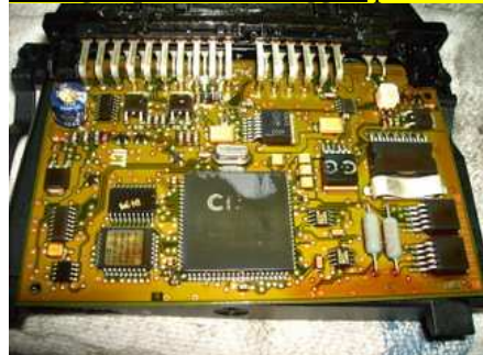
Centralina EGS vista interna, dalla W211 esistono barriere d'olio nel cablaggio motore!
