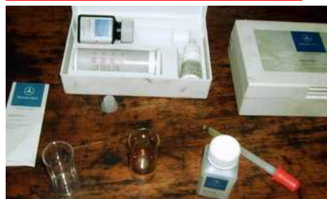
Test glicole MB per ad es. W203, W209, W211 OK fino a 100 mg per litro olio . Più di 100mg per litro d'olio, cambiare radiatore e lavare il cambio. Se dopo il lavaggio non migliora Daimler consiglia la sostituzione del convertitore!!!
