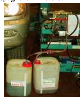
La coppa d'olio viene riempita con motore spento con 5 litri olio nuovo (fino al segno 3,5/(2,5) litri ) accendendo la poma d'olio 12V.
