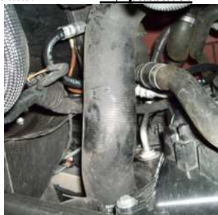
Connettere adattatore ad es. W251/ W164 320CDI sopra al radiatore (Ritorno). Con adattatore a chiusura rapida meglio da sopra!
