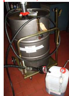
versare 10,5 litri olio nuovo nel bidone olio nuovo ( 12,5 litri olio nuovo solo con X204, W204+212+216+221 4Matic )
