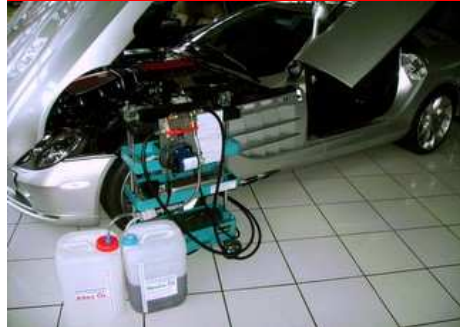
Il sistema di lavaggio con i bidoni
