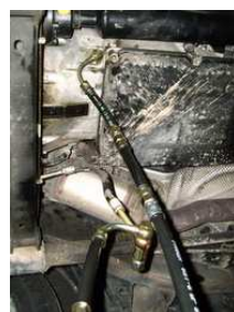
il tubo sinistro con connessione anello a curva viene montato a sinistra (mandata). il tubo destro viene montato al tubo che porta allo scambiatore di calore.
