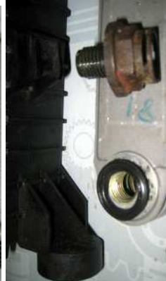
Scambiatore calore Valeo aperto che perde dalla W211, 270CDI. Le guarnizioni difettose causano la contaminazione glicole!
