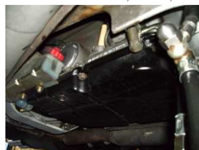
Porsche 928 S4 con cambio automatico MB. Lavaggio come dal 7-marce, siccome non c'è asta di controllo olio però tanica di trabocco accanto alla coppa d'olio!
