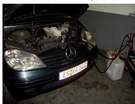
Chrysler 300C T 3.0 CRD + Grand Cherokee MB 5G. Connesso al Vaneo + alla classe A W168, tutte e due quantità olio da cambiare ca.7 litri.
