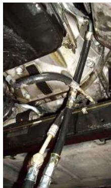
Adattatore W163, ML 400CDI V8, adattatore AMG ML55. Qui si deve usare per il ML un'altra vite cava (nella foto in alto).
