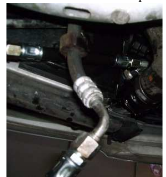
W220, S500 7-marce, connesso con adattatore ad angolo a 90 gradi!
