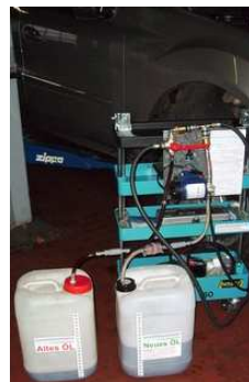
Connettere adattatore ad es. W221 sotto allo scambiatore calore. Sempre il tubo di ritorno destro!
