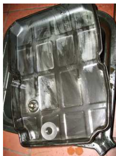
pulire coppa d'olio. S'è necessario Aggiungere una calamita filtro olio A1402770095 guarnizione A1402710080 EGS: A 203 540 02 53
