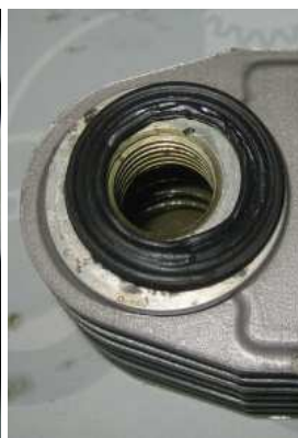
Scambiatore calore Valeo aperto che perde dalla W211, 270CDI. Le guarnizioni difettose causano la contaminazione glicole!
