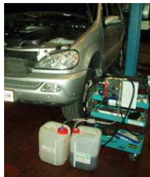
Inizio con 10/(9) litri olio nuovo ad. es. dal W163 ML 400 CDI in posizione cambio (leva orizzontale).
