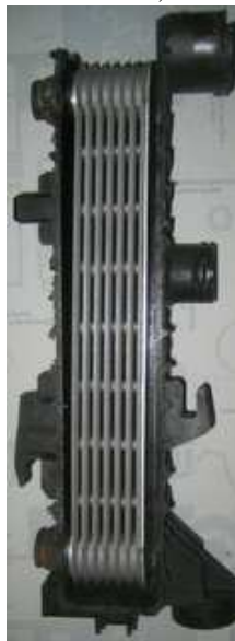
Scambiatore calore Valeo aperto che perde dalla W211, 270CDI. Le guarnizioni difettose causano la contaminazione glicole!
