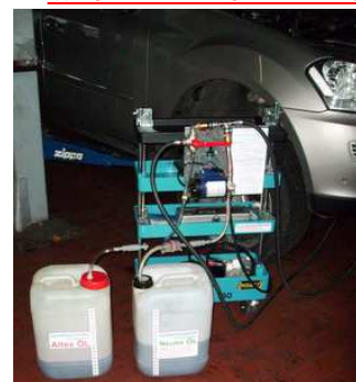
versare 10,5 litri olio nuovo nel bidone olio nuovo ( 12,5 litri olio nuovo solo con X204, W204+212+216+221 4Matic )
