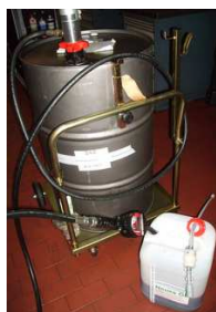
10 litri olio nuovo vengono pompato nel bidone olio nuovo (9 litri olio nuovo con scambiatore calore piccolo).
