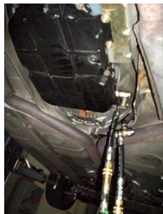
Porsche 928 S4 con cambio automatico MB. Lavaggio come dal 7-marce, siccome non c'è asta di controllo olio però tanica di trabocco accanto alla coppa d'olio!
