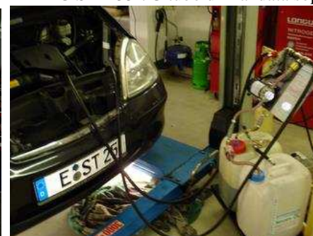
Chrysler 300C T 3.0 CRD + Grand Cherokee MB 5G. Connesso al Vaneo + alla classe A W168, tutte e due quantità olio da cambiare ca.7 litri.
