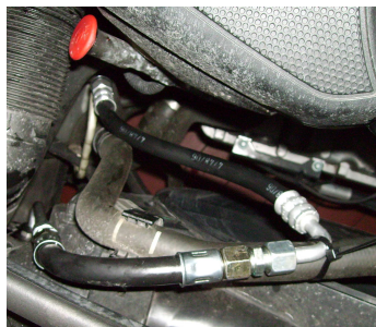
Adattatore al W164, ML 320CDI per giro di prova con detergente, By-passato!
