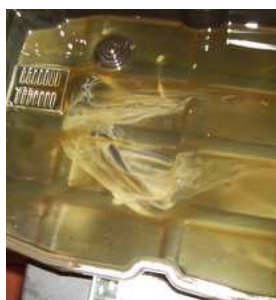
Smontaggio della coppa d'olio. Non si deve svitare il tappo di scarico olio. Olio usato del filtro olio+coppa d'olio viene raccolto. Cambiare filtro olio +guarnizione. 0,3-0,5 litri olio usato rimanente Dalla coppa d'olio e dal filtro viene versato nel bidone Aprire brevemente rubinetto di scarico della stazione service
