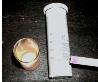
Test glicole MB per ad es. W203, W209, W211 OK fino a 100 mg per litro olio . Più di 100mg per litro d'olio, cambiare radiatore e lavare il cambio. Se dopo il lavaggio non migliora Daimler consiglia la sostituzione del convertitore!!!
