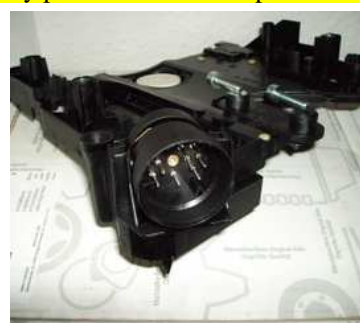
Componente elettrico con sensori giri magnetici.
