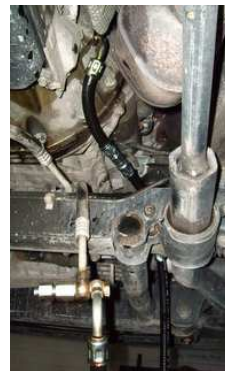
Adattatore W163, ML 400CDI V8, adattatore AMG ML55. Qui si deve usare per il ML un'altra vite cava (nella foto in alto).
