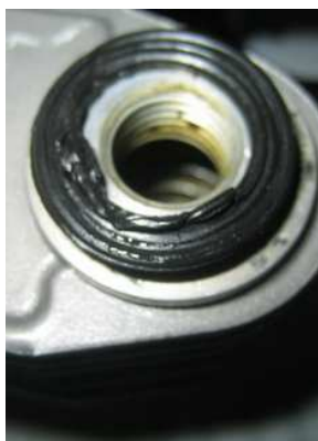
Scambiatore calore Valeo aperto che perde dalla W211, 270CDI. Le guarnizioni difettose causano la contaminazione glicole!
