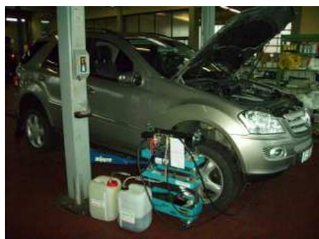
Connettere adattatore ad es. W251/ W164 320CDI sopra al radiatore (Ritorno). Con adattatore a chiusura rapida meglio da sopra!
