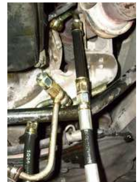
Adattatore al Vito con cambio 722.6 solo tramite vite cava.
