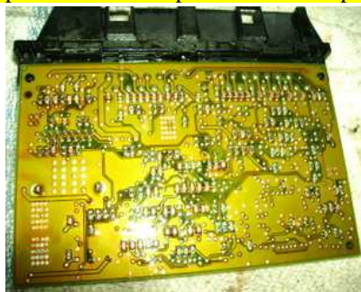
Centralina EGS vista interna, dalla W211 esistono barriere d'olio nel cablaggio motore!
