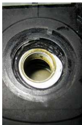
Scambiatore calore Valeo aperto che perde dalla W211, 270CDI. Le guarnizioni difettose causano la contaminazione glicole!
