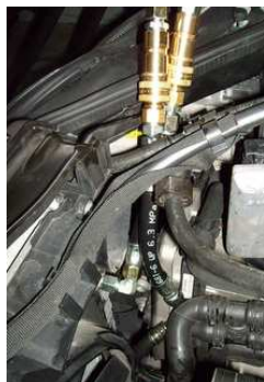
AMG SL55 W230 sopra con adattatore ad angolo. Funziona così anche dal W220/W230!
