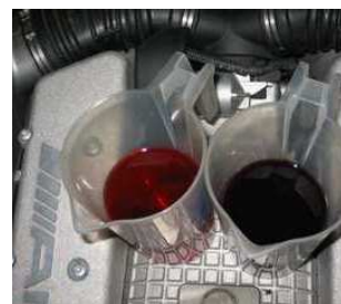
Olio cambio automatico usato dal AMG G55, 2/2006, 25.600km..
