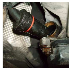
Montare coppa d'olio ( 8 Nm ) staccare presa EGS e controllare se ci sono infiltrazioni interne, eventualmente sostituirlo ( 2,5Nm )!
