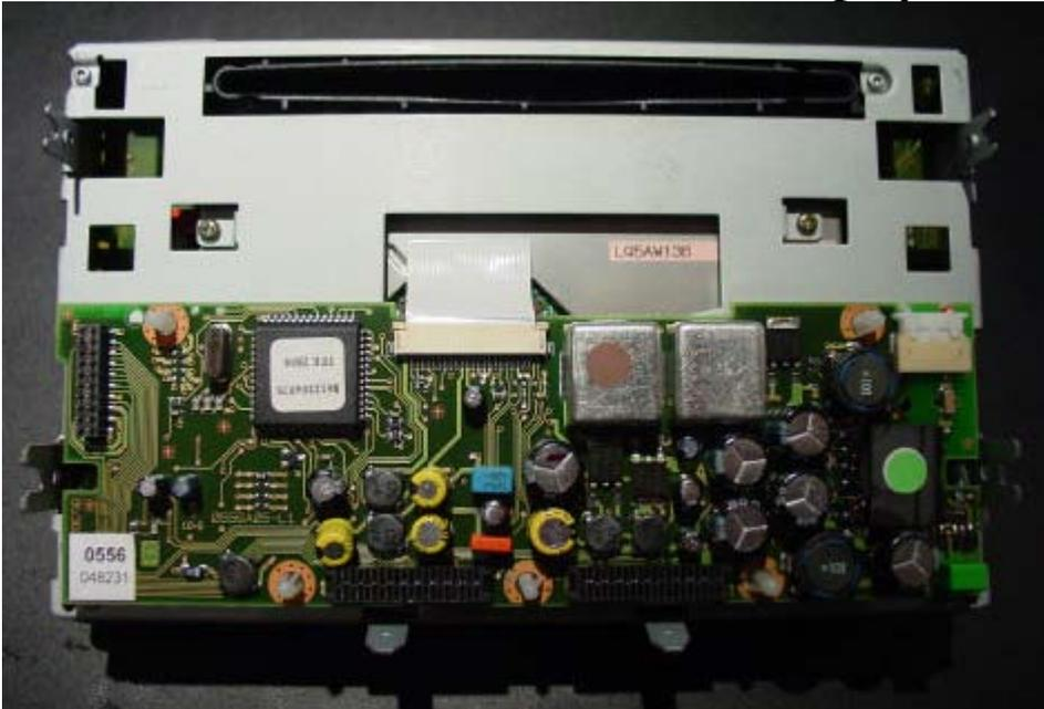
Saldare sul connettore che appare sulla sinistra sui due pins più in basso un filo elettrico:
