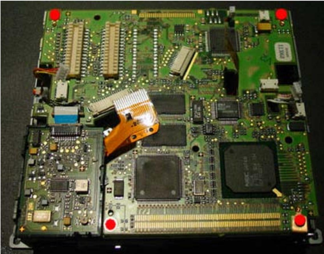
Rimuovere la scheda sulla superficie inferiore del lettore CD, smontando il connettore in foto e le viti.
