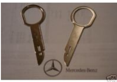
Chiavi per smontare il Comand nella maggioranza delle Mercedes
